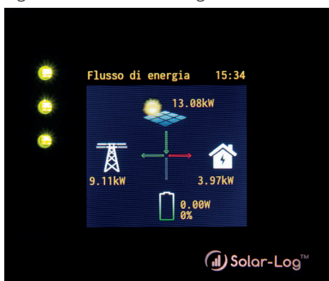
Fig.: Esempio impianto con flusso di energia
